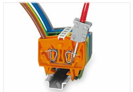
Connexion CAGE CLAMP® sur rail conducteur - courant nominal max. 6 A ; la connexion CAGE CLAMP® serre des contacts de test individuels La tension de test maximale est 400 V.
