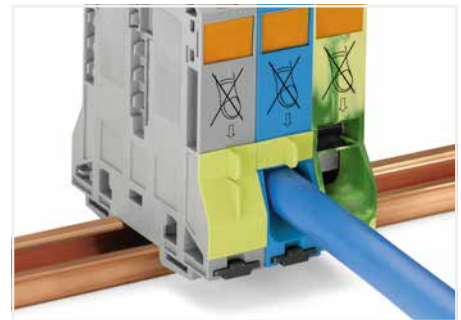
L'obturateur d'isolation jaune sert de protection contre le contact accidentel du logement de pontage et/ou des points de connexion sans conducteurs (divisibles).
