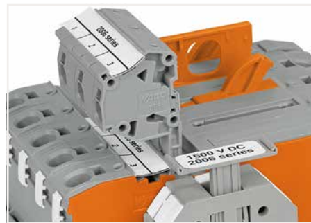
La mesure peut aussi être effectuée avec des connec- teurs ((2006-511) de la borne 1 à 2. D'autres modules vides ((2006-549) doivent être utilisés pour compenser le pas de la borne de 15 mm.
