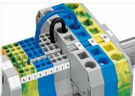
Pontage avec ponts réducteurs des bornes d'une section plus grande avec des bornes d'une section inférieure.
