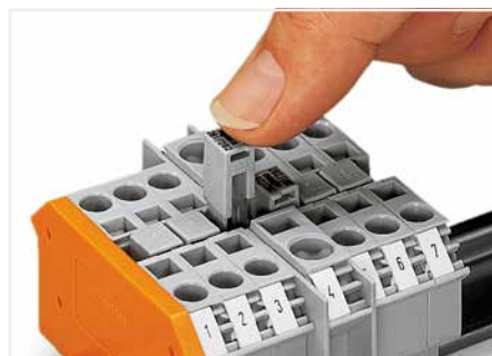
Pontage des bornes d'une section plus grande avec des bornes d'une section inférieure Bien pousser le pont réducteur jusqu'en butée !
