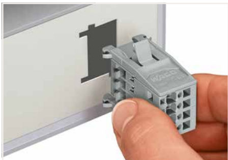
Enficher le connecteur mâle avec les brides à encliqueter (769-604/005-000) dans la découpe.
