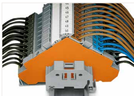
La fiche à fusible est 1 mm plus large que la borne. Com- penser cette différence par une plaque intermédiaire.
