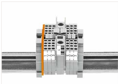
Pontage avec ponts réducteurs de bornes sur rail 6 mm 2 (série 282) à des bornes sur rail 1,5 mm 2 (série 279)
