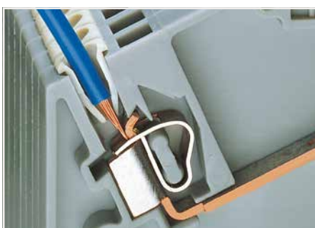
Réducteur isolant de sécurité Pas de pénétration de l'isolation du conducteur dans le point de serrage ! Disponible pour bornes jusqu'à 4 mm 2
