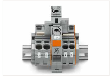
Pontage avec ponts réducteurs de bornes POWER-CAGE-CLAMP (35 mm 2 ) sur bornes TOPJOB® S (10/16 mm 2 ) séries 2010 et 2016 (mais pas pour 2016-76xx et 2016-77xx)
