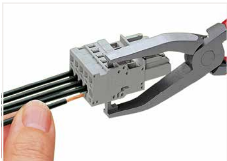
Outils de manipulation Connexion du conducteur — « câblage latéral », dans l'exemple, un connecteur femelle En utilisant des conducteurs de section nominale avec des embouts d'extrémité, il faut prendre à chaque fois la section de conducteur directement inférieure.
