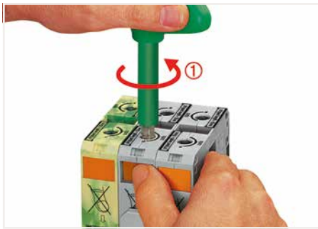
Raccordement du conducteur – étape 1 Tourner la clé à six pans dans le sens contraire des aiguilles d'une montre jusqu'en butée, puis appuyer sur le poussoir orange (fonction de blocage), le point de connexion reste ouvert.
