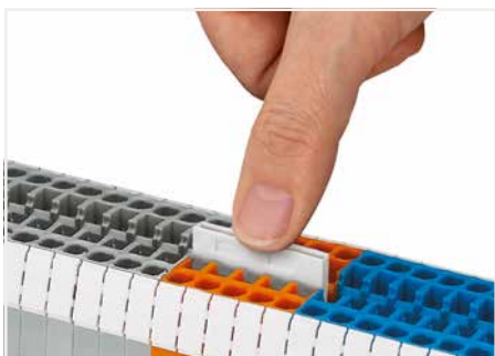
Insérer les peignes de pontage jusqu'en butée (en appuyant alternativement à gauche puis à droite et ainsi de suite) ! Peigne de pontage 1-3-5-7 ou 1--4--7 sur demande
