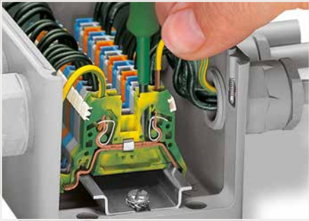
Connexion CAGE CLAMP® Raccordement du conducteur (0,08 ... 4 mm 2 « s »). En utilisant des conducteurs de section nominale avec des embouts d'extrémité, il faut prendre à chaque fois la section de conducteur directement inférieure.
