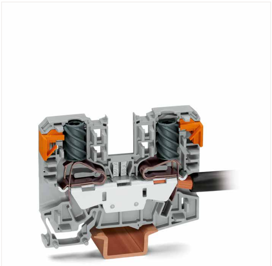
Raccordement du conducteur – étape 3 Un petit tour à gauche et le système de blocage est déverrouillé ①. Dès que le tournevis est retiré, le conducteur est parfaitement connecté.
