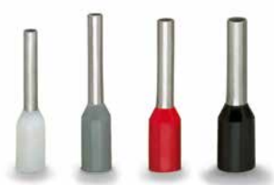
Embout d'extrémité avec isolation plastique ; étamé par électrolyse ; cuivre électrolytique ; serti de manière étanche aux gaz ; selon DIN 46228, partie 4/09.90
