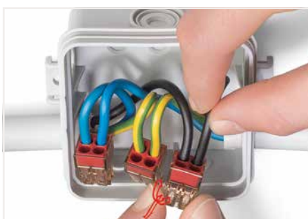
Pour déconnecter : tenir le conducteur, et retirer la borne par des mouvements rotatifs avec une légère traction.
