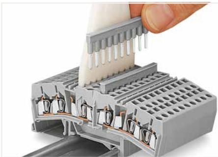
Peut servir de multiplicateur de potentiel. Insertion d'un peigne de pontage à 10 pôles (possible uniquement au centre de la borne !)
