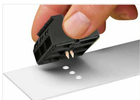
Contact direct du contact de terre avec la plaque de montage. Pénétration automatique d'une éventuelle couche de vernis
