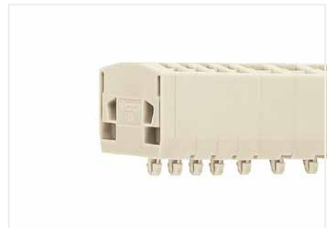
Barrette à bornes Ex e II ; avec pieds de fixation à encliqueter ; pour épaisseur de tôle 0,6 mm ... 1,2 mm ; diamètre des trous de fixation 3,5 mm
