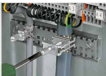
Après la fixation, il suffit de serrer la vis moletée. Couple de serrage recommandé de la vis 0,5 Nm
