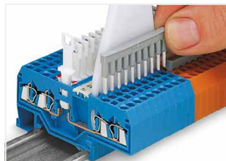
Pontage de bornes sectionnables à câblage frontal à l'aide d'un peigne de pontage à 10 pôles.
