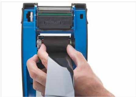
Mettre en place le ruban encreur.
