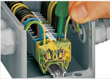
Connexion CAGE CLAMP® Raccordement du conducteur. En utilisant des conducteurs de section nominale avec des embouts d'extrémité, il faut prendre à chaque fois la section de conducteur directement inférieure.
