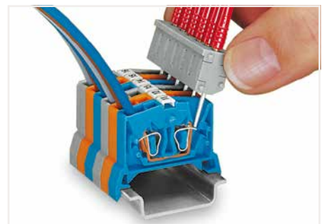
Contact direct, sur le ressort de la connexion CAGE CLAMP®, le courant nominal est limité à 0,5 A et la tension de test maximale à 48 V ; les broches de test ne sont pas protégées contre les contacts.
