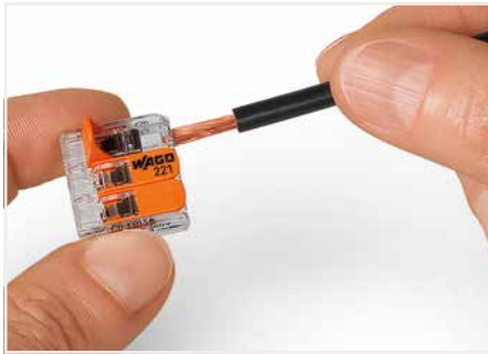
Raccordement du conducteur : ouvrir le point de connexion à l'aide du levier et introduire le conducteur.
