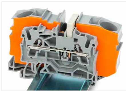
Contact de pontage réducteur (2016-499) : de 16/10 mm 2 (séries 2016/2010) à 10/6/4/2,5 mm 2 (séries 2010/2006/2004/2002)
