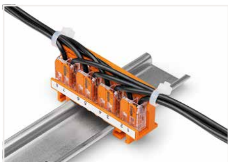
Décharge de traction à l'aide d'un serre-câble monté sur l'adaptateur, à travers le sens de raccordement de la borne ; repérage des points de connexion grâce à une bande de marquage (210-334)
