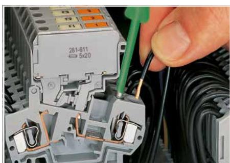
Connexion CAGE CLAMP® Raccordement du conducteur. En utilisant des conducteurs de section nominale avec des embouts d'extrémité, il faut prendre à chaque fois la section de conducteur directement inférieure.
