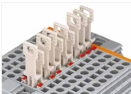
Tirette de sectionnement avec indication colorée de l'état de commutation (couleur rouge visible = état sectionné)
