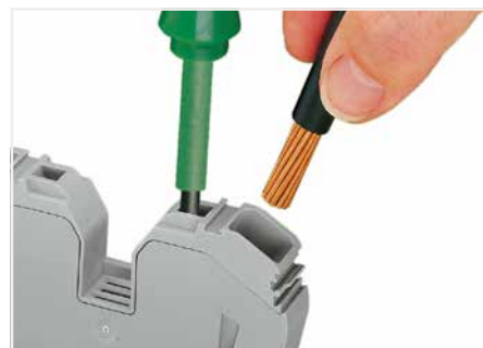
Raccordement du conducteur (35 mm 2 )
