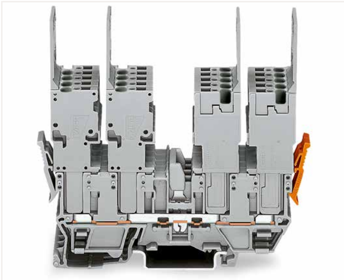
4 x Connecteur femelle pour 1 conducteur Les bornes de base peuvent être pontées avec des systèmes de pontage de la série 280 et 780, possibilité de test avec adaptateur de test, réf. 280-4...
