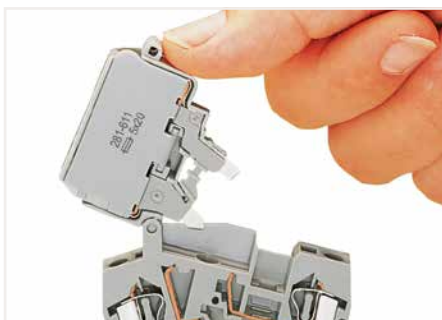
Remplacement du fusible Avant de remplacer le fusible, faire pivoter le porte-fusible vers le haut jusqu'au cran d'arrêt
