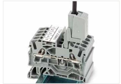
La fiche de test (2009-182) est appropriée pour les séries 2000 à 2016 pour le raccordement sans outil des fils d'essai individuels jusqu'à 2,5 mm 2 .
