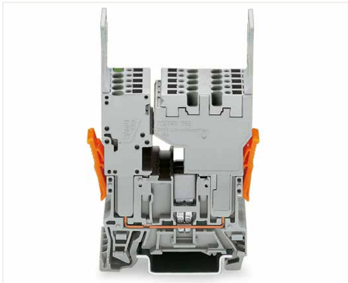
Connecteur femelle pour 1 conducteur et connecteur femelle pour 2 conducteurs Les bornes de bases ne peuvent être pontées qu'avec des contacts de pontage horizontaux et alternants de la série 280.
