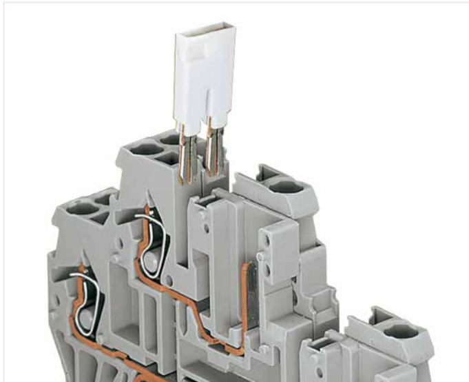
Pontage avec peignes de pontage de borne de passage à 2 étages (870-501) avec borne à 2 étages 1 conducteur/1 broche (870-101)
