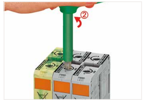
Raccordement du conducteur – étape 3 Tourner vers la gauche pour déverrouiller le ressort de serrage. La clé à six pans est libérée. Le conducteur est parfaitement serré.
