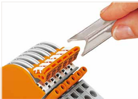
Couvercle de verrouillage encliquetable sur leviers sectionneurs pour 1 à 8 leviers sectionneurs, utilisable : a) en tant que verrouillage mécanique pour commutation de plusieurs pôles, ou b) comme protection pour étiquettes de marquage
