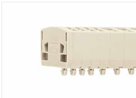
Barrette à bornes Ex e II ; avec pieds de fixation à encliquer ; pour épaisseur de tôle 0,6 mm ... 1,2 mm ; diamètre des trous de fixation 3,5 mm
