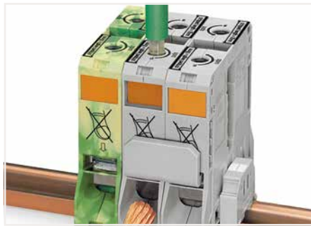
Raccordement du conducteur – étape 2 Introduire le conducteur dénudé dans le point de connexion jusqu'en butée et le maintenir dans cette position.
