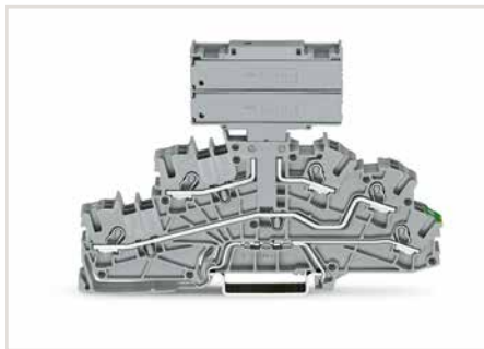
Dans des bornes de base sans sectionneur du neutre, on peut utiliser des fiches à fusibles doubles avec cartouches 5 x 20 mm dans la largeur de bornes standard.
