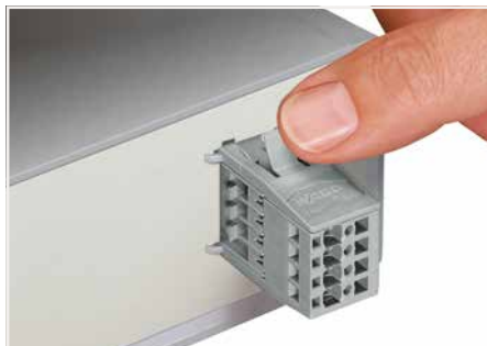
Pour démonter, desserrez les languettes à l'aide d'un outil de manipulation et pressez ensemble les éléments mobiles.
