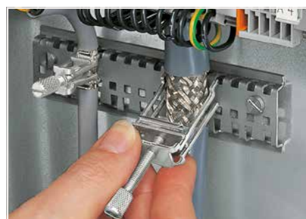
Pour enlever l'étrier de serrage de blindage, desserrer la vis moletée au-delà du point de pression, puis retirer l'étrier en l'inclinant légèrement
