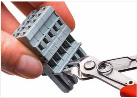
Codage d'un connecteur femelle - Enlever la(les) tige(s) de codage à l'aide d'un outil coupant Ne pas détacher ni la 1ère ni la dernière tige de codage, elles servent à la fixation.
