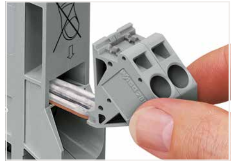
Prélèvement direct et sûr au point de l'alimentation ; l'enfichage de la borne de prélèvement s'effectue cage à ressort en position ouverte et sans conducteur.
