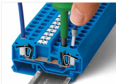
Connexion CAGE CLAMP® Raccordement du conducteur. Pour les conducteurs munis d'embouts d'extrémité, il faut choisir une borne acceptant une section nominale de taille supérieure.
