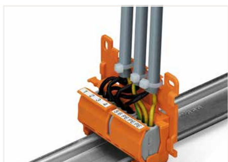
Montage vertical avec plaque de décharge de traction sur rail DIN 35 ; Repérage des points de connexion grâce à la bande de marquage.
