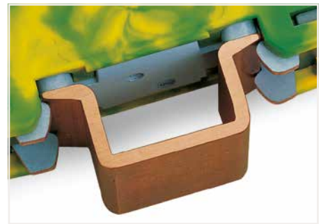
Pied de contact de terre Les bornes de terre (conformément à la norme EN 60947-7-2, limitées au max. à 120 mm 2 ) doivent absolument être encliquetées sur un rail en cuivre (épaisseur 2,3 mm).
