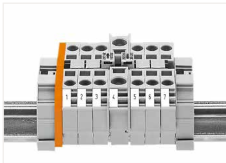
Pontage avec ponts réducteurs de bornes sur rail 10 mm 2 (série 284) à des bornes sur rail 6 mm 2 (série 282)
