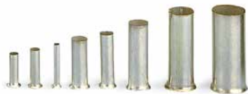
Embout d'extrémité sans isolation plastique ; étamé par électrolyse ; cuivre électrolytique ; serti de manière étanche aux gaz ; selon DIN 46228, partie 4/09.90
