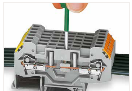
Déplacer le levier de sectionnement pour les bornes sectionnables et de mesure
